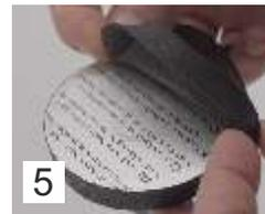
a) Dopo aver pulito la superficie del magnete con straccio e alcool, staccare la cartina autoadesiva in pvc argento dal supporto (foto 1) ed applicarla in modo uniforme e senza pieghe (foto 2 e 3).
