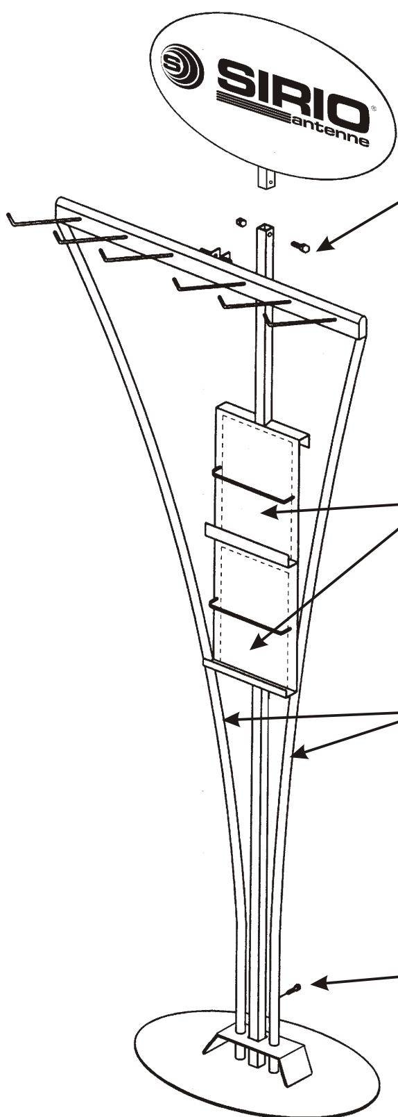
**I** Inserire con forza l'ovale superiore quindi montare la barra orizzontale e bloccare con l'apposita vite.
